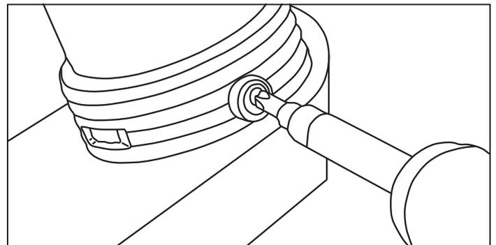
3. Retirez la vis qui tient en place le tube UV sous le ballast UV.
