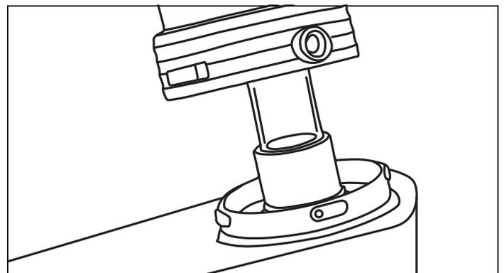
4. Soulevez le couvercle du tube UV afin de le retirer et d'examiner le tube quartz.
