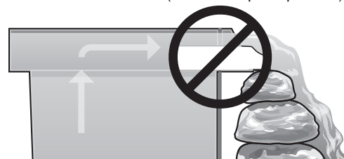
Ex. 9 Si vous utilisez une pierre naturelle pour la lèvre de votre chute d'eau, assurez-vous qu'elle soit suffisamment fine (moins de 3/4 po d'épaisseur).
