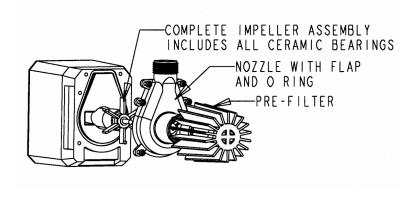
1½" INSIDE DIAMETER IS THE MINIMUM HOSE SIZE THAT SHOULD BE USED FOR MAXIMUM FLOW
